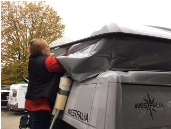
2. Von den Ecken aus arbeiten Sie jeweils in Richtung Mitte. Dabei kletten Sie die Thermohaube von innen an die Dachinnenseiten. Greifen Sie dazu unter dem Vorhang durch.
