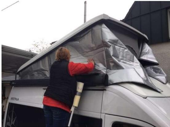
4. Nachdem die Ecke und die Seite gerade angeklebt wurden, lassen Sie die Front einfach hängen. Diese fixieren Sie dann von der anderen Seite. Standardmäßig ist die Front einteilig. Die Seitenteile werden glatt über das Fahrzeug gelegt.
