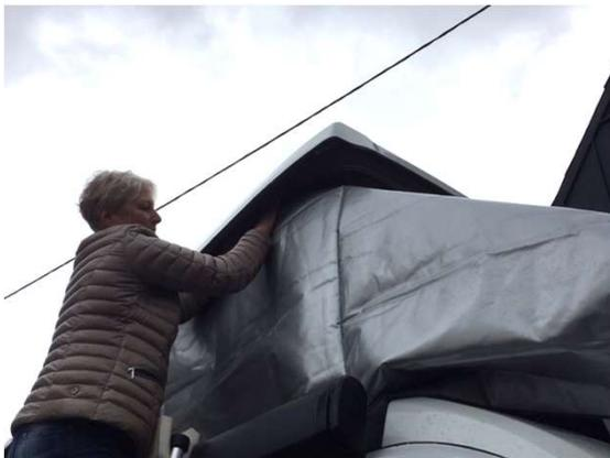
Bei der Demontage fahren Sie mit den Händen direkt zwischen den beiden Klettstücken entlang. Sprich zwischen Haube und Dach.
